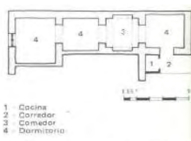
Fig.III.17 - Esquema de casa típica no bairro de pescadores de Rota, povoação a norte da baía de Cádiz, também organizada linearmente, numa sucessão de espaços destinados a dormitórios, com uma sala de jantar central e cozinha num extremo, com cobertura em abóbada de canhão que se transforma, na sala de jantar, numa abóbada de vela.
