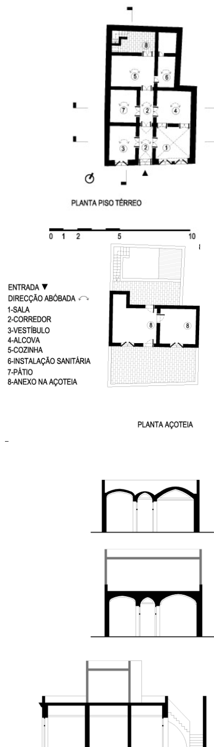
Fig.III.33 – Exemplo de tipologia bilateral composta e de conjunto arquitectónico na Rua Dr. Teófilo Braga nº34 (B.06). Escala 1:300.
